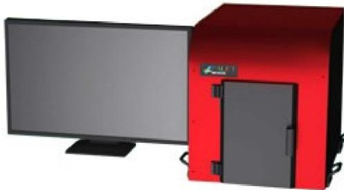
②AU-PALET\_new 是 AU-PALET 的升级版本，在光源上采用波长更短的 365nm 的 LED 灯作为光源，采用 10×的物镜曝光面积达到 1mm×0.6mm，光刻分辨率达到 3μm，并在 1s 内完成曝光。
