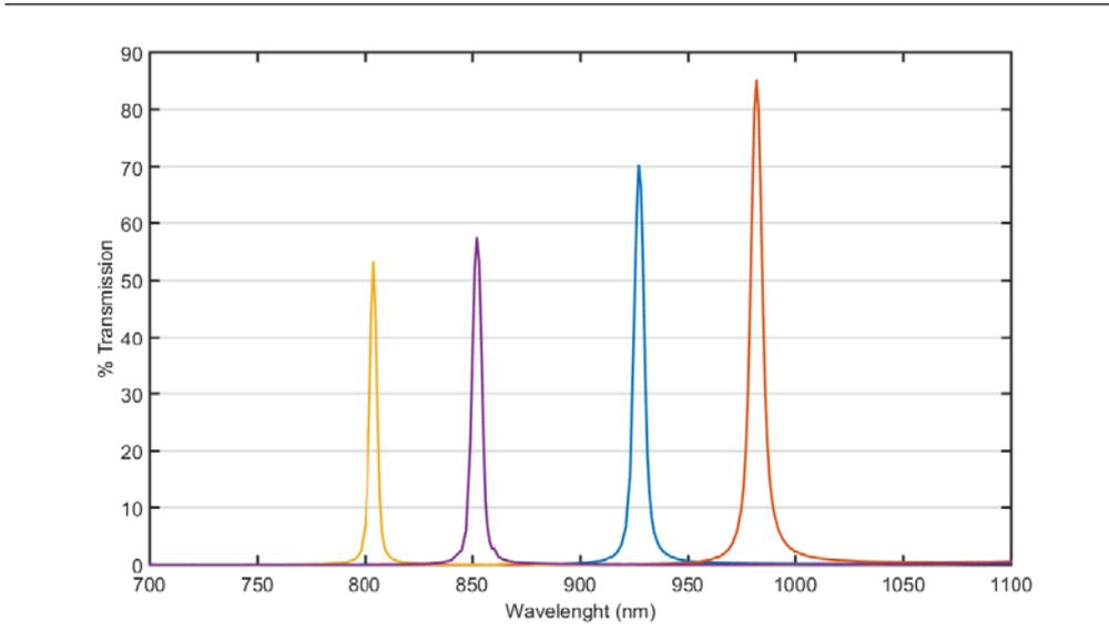
案例，四通道多光谱相机，波长分别为 800 nm , 850 nm, 930 nm, 980 nm。从如上图中可以看到我们独特的微结构滤波片的独具的高透过率及窄线宽的特点。同时客户也可以看出我们滤光片对带外的光的极好的过滤效果。
