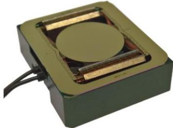
2) 二维电磁驱动微型振镜，其由两个一维 MEMS 微型振镜组成，可接受的最大激光光斑为 8mm，在 X 和 Y 方向的偏角可分别达到  $\pm 10^\circ$ 。
