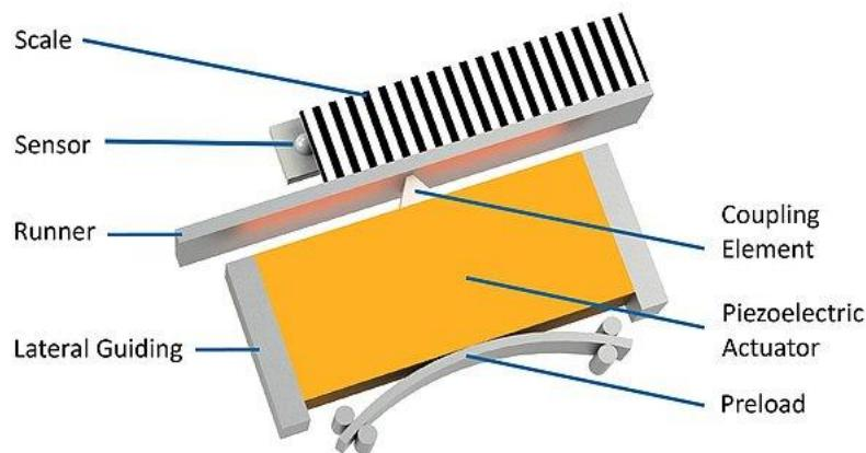
理论上压电马达平移台的行程仅取决于转子的长度，因此 AU-XLS 系列位移平台可提供的行程范围可达 94mm，采用线性编码器位置传感器闭环控制，使位移平台的位移分辨率可达到 78nm，在满足大行程的同时实现了高的精度。由于压电陶瓷已经加载了预加力，因此断电之后平移台会有自锁功能，使位移平台依然保持在原位。这样可以减少了能源的消耗和产热量，提高了位移平台的精度。
