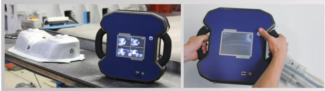
自主测量头保证操作方便；它由电池供电且无需电缆。一个按钮触发器记录一组 4 台同步相机，分辨率为 500 万像素。数据可以在线传输或存储以备后用。集成显示器允许在测量模式下进行视觉图像控制。
