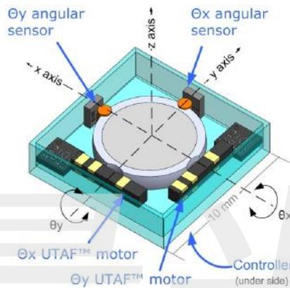
③超紧凑里斯利（Risley）棱镜光束控制系统。包含两个可绕着光轴独立运动的楔形的棱镜。通过连续的控制棱镜的方向来改变光束的方向，光束的偏转角度可达到 $\pm 6^\circ$  原理如下图所示。
