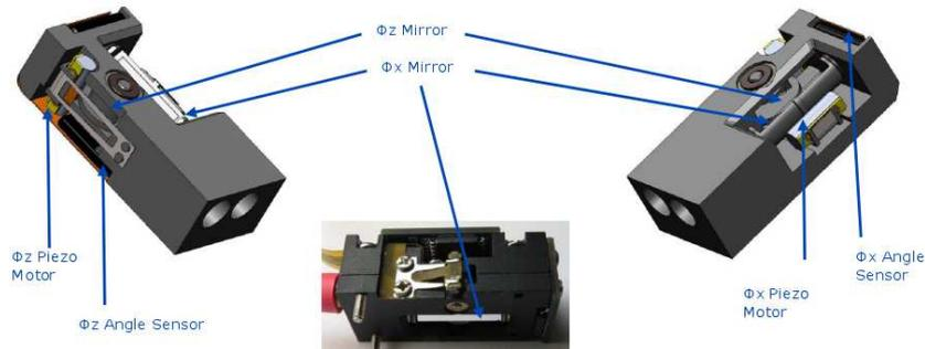
②**单反射镜二维光束控制系统**。该系统包含一个反射镜、两个压电马达、两个角度传感器、
