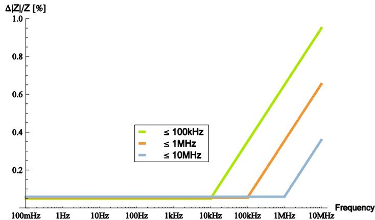
Die Wahl des Frequenzbereiches beeinflusst auch die Genauigkeiten der Impedanzmessung. Dieser Zusammenhang ist schematisch für eine Messung dargestellt.
