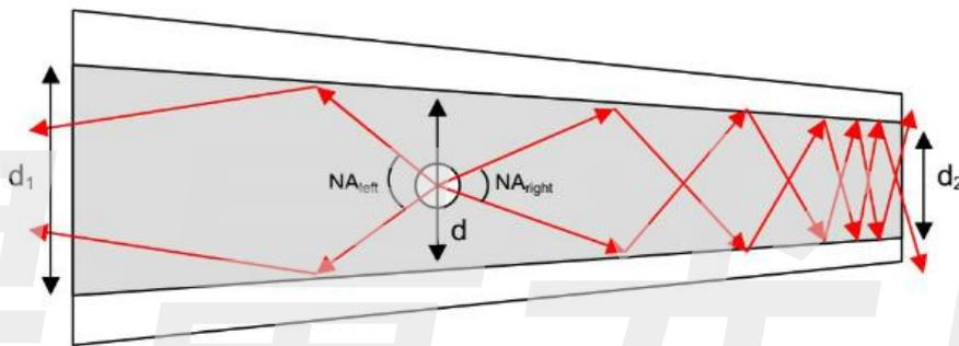
图 1、锥形光纤示意图, 芯径  $d_1 > d_2$
