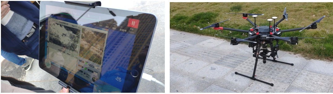
图 4 地面飞行控制系统及无人机载系统
