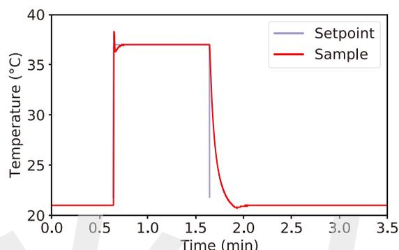
无额外热负荷的智能基板温度响应
