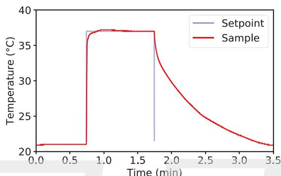
贴附在200  $\mu\text{L}$ 水热负载上的智能基板的温度响应
