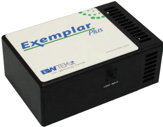
Exemplar Plus是一款高性价比的背照式光纤光谱仪。采用非交叉式CT结构光路，具备极低的杂散光水平。其采用的2048像元背照式高灵敏度CCD阵列，使得其在紫外、可见和近红外波段都具备优异的表现。其光谱覆盖范围在190-1100nm，用户可选定制波段和分辨率要求。
