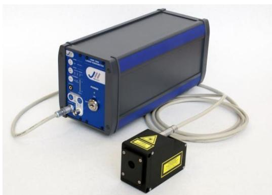
意大利 Julight 单点激光测振仪采用半导体作为激光源，以及基于最先进和新颖的自混合干涉技术方案将直接到激光头腔体里的散射光和标准激光源进行干涉处理，这样大大简化了激光头的设计，测量目标表面法向方向的位移量。
